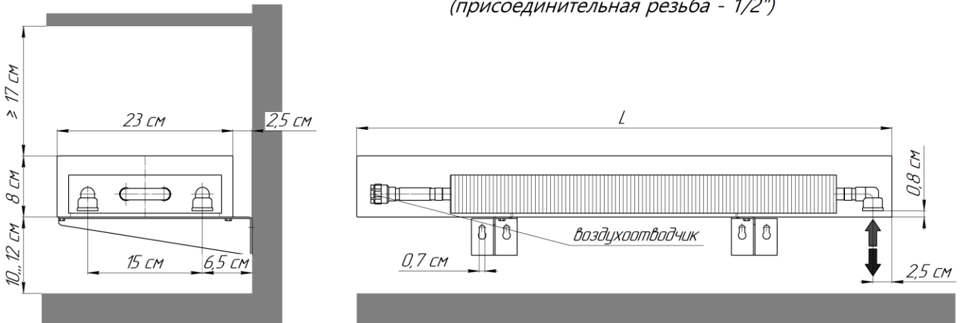
Настенный конвектор "Элегант - мини 230х80-2то Стен прав" с правосторонним нижним подключением (левостороннее - зеркально) (присоединительная резьба - 1/2")
